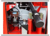
Централизованная система смазки значительно сокращает объем ежедневного техообслуживания и расходов на персонал.
