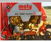
Для равномерного выбрасывания тыквенных отходов на поле. Для ускорения процесса гниения. Благодаря этому поле будет быстрее и в оптимальное время подготовлено к следующей посадке.
