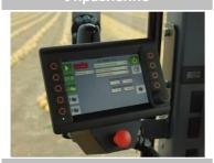
Электронное управление с дисплей. Для удобного управления комбайна из трактора. Конвейер и измельчающий барабан можно регулировать на дисплей. Счётчик часов работы с
