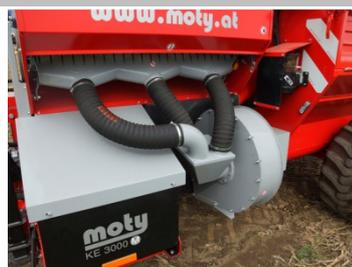
Благодаря тройному всасывающему желобу воздух распределяется в отсасывающем барабане более равномерно и эффективно. Скорость вращения отсасывающего барабана регулируется гидравликой
