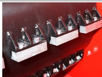
Привинчаемыми дробительные планки зубков измельчающего барабана можно просто сменить в случае износа. Длинная стойкость- планки из закалённой стали.
