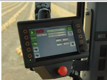
Электронное управление с дисплей. Для удобного управления комбайна из трактора. Конвейер можно регулировать на дисплей. Счётчик часов работы с функцией „reset“
