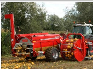
Во время уборки урожая комбайн должен находиться под уклоном назад. Автоматическая регулировка уровня устанавливает стабильный угол наклона- более эффективный процесс уборки.
