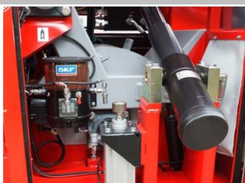
Централизованная система смазки значительно сокращает объем ежедневного техобслуживания и расходов на персонал.
